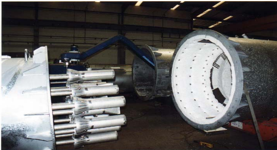
Bild 3 – Isolierung einer Hochtemperatur-Fackelanlage (Quelle: Haase, Neumünster)
