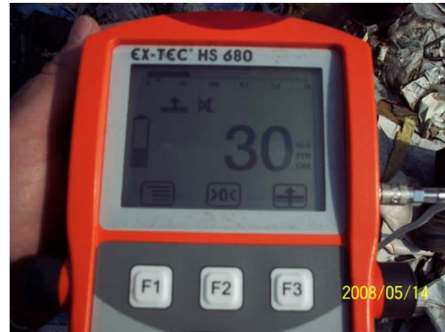
Abb.10 Messwert, Begehung zur Ermittlung von Kohlenwasserstoffen auf einem Abfallzwischenlager mit einem Kombi-gerät [DAS-IB GmbH, 2008]
