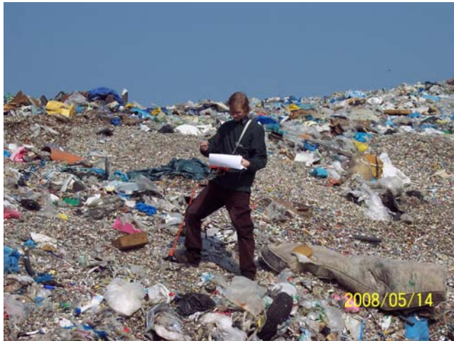
Abb.9 Begehung zur Ermittlung von Kohlenwasserstoffen auf einem Abfallzwischenlager mit einem Kombi-gerät [DAS-IB GmbH, 2008]
