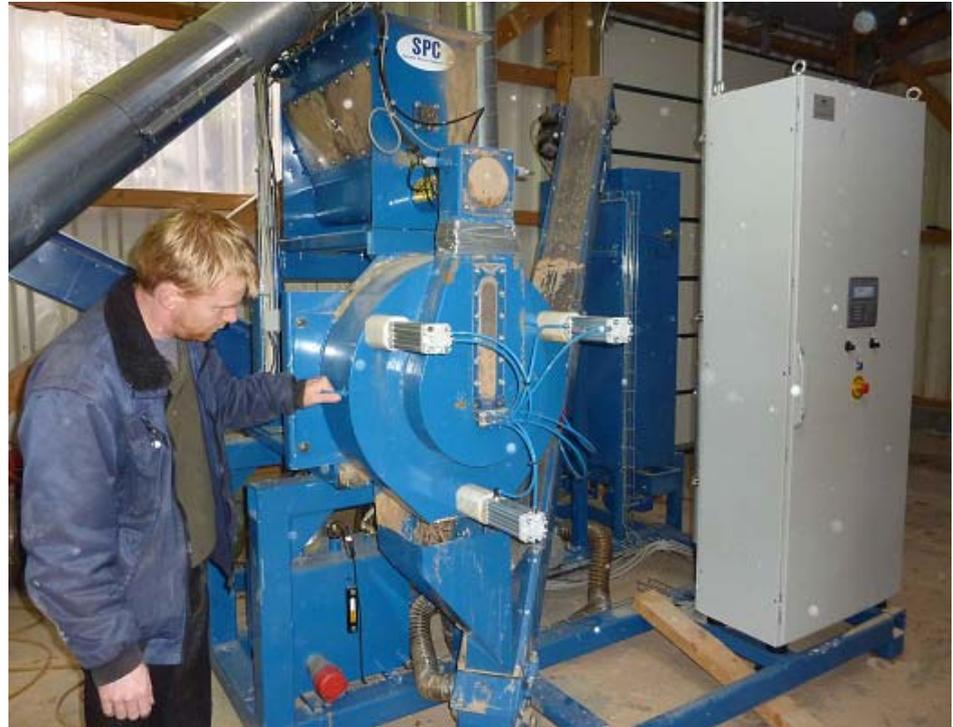
Foto: Pelletierer mit separater Steuerung
