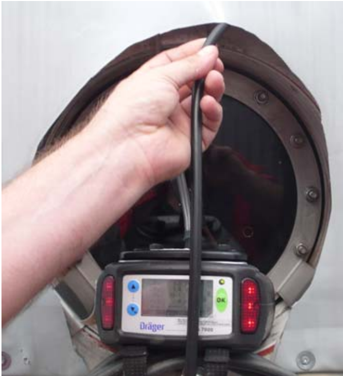
Abb. 1: Dichtigkeitsmessung mit PSA [eigene Aufnahme]
