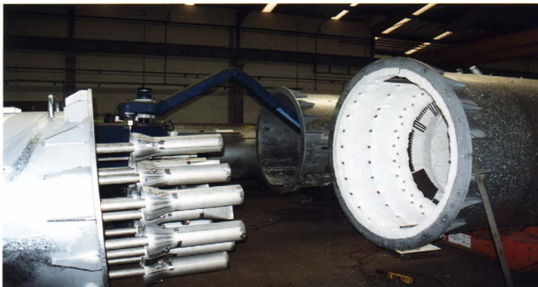
Bild 3 – Isolierung einer HTV (Quelle: Sta für Haase, Neumünster) rechts im Bild
